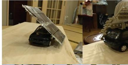
ソーラーパネルはカールーフに設置可能で、開くと16枚(約8畳)のパネルとなり、畳むと屋根のキャリアに収まる。発電能力は最高1600whで、バッテリーに充電される。
